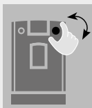
Ventiel openen / sluiten
